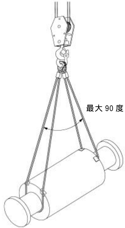
圖 16 兩條單支腳吊索以 籃式索結法使用
